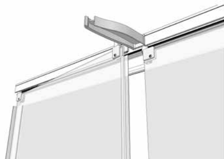
Systém otevírání – horní část (detail horního výjezdu)
